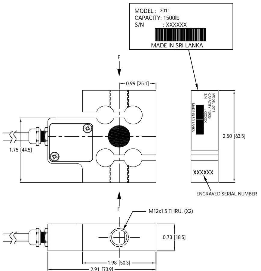
NOTE: SHOWN LOADING DIRECTION IS FOR POSITIVE OUTPUT
