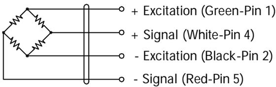
CABLE : 26AWG 26 AWG COLOR CODED AMPHENOL RIBBON CABLE
