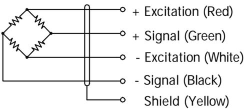
Cable : 28 AWG, 4 Conductor cable.
