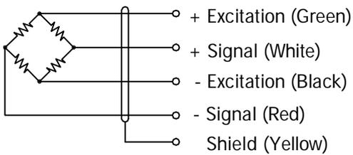
Cable : 24 AWG, 4 Conductor cable.
