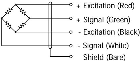
Cable : Ø5.1mm 4 Conductor cable.
